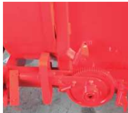
TRANSPORTADOR DE CADENAS MECÁNICO CON 3 VELOCIDADES.
